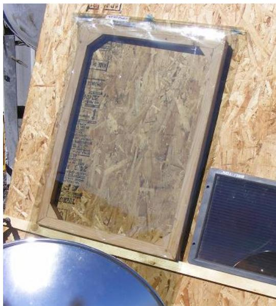
**FIGURE 4. SOUTHWALL SOLIS-VK70 FILM TEST FRAME, NEXT TO PV PANEL**
