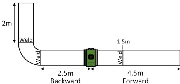
**FIGURE 1:** GEOMETRY OF THE 8 INCH SCHEDULE 40 TEST PIPE.
