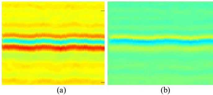
**FIGURE 4:** B-SCAN IMAGE OF DELAMINATION WITHIN WAVY COMPOSITE FROM (A) LONGITUDINAL WAVE AND (B) SHEAR WAVE
